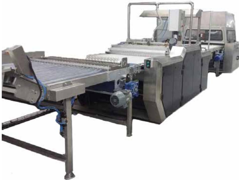
Conçu pour placer guimauve / ou crème entre biscuits durs et mous. Le système peut être alimenté manuellement ou automatiquement. Les servomoteurs sont utilisés pour gérer facilement et travailler avec différents produits. Système de dépôt et de sandwich en aluminium et les surfaces qui touchent les produits fabriqués par des matériaux alimentaires sûrs.
