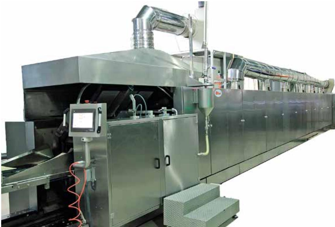
Conçu pour cuire la pâte de gaufrette et en faire des feuilles de gaufrettes. Température du four contrôlée par le système PLC et actionnée par un écran tactile. Le système de combustion peut réguler le feu et normaliser le processus de cuisson. La pâte à gaufrette est transférée par pompe aux plaques de four. Bien isolé pour éviter toute perte de chaleur.
