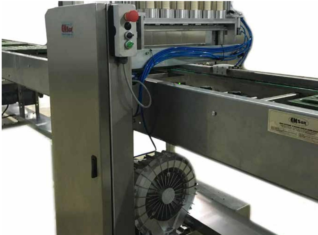
Conçu pour placer la capsule dans les moules à gâteaux. Alimente automatiquement la capsule au centre des cellules pan. Le système de placement de capsules est autorisé à utiliser différents types de produits et à fonctionner avec la chaîne de production. Le système peut être éteint s'il n'y a pas besoin de capsule.
